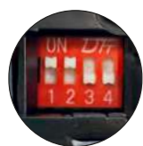
Regulacja mocy DIP-switch
